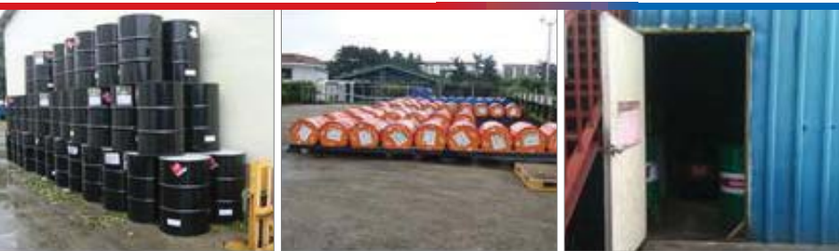
개선전 | 가스시설 부지내 위험물 저장시설이 있음에도 위험물을 저장시설 이외 공간에 보관하여 사고 발생 위험이 높다.
