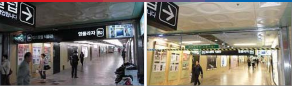
개선전 | 제연경계벽이 설치되어 있지 않은 통로 개선후 | 제연경계벽 설치
