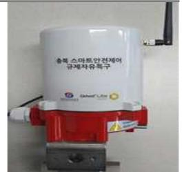
이후 A사는 충북 스마트 안전제어 특구에 사업자로 참여하여 시제품 개발을 실증했고 안전성을 검증받았으며, 그 결과 **'무선 기반 가스용품의 스마트 안전 차단·제어 기술 상세기준(KGS code)'이 마련**되었다. A사는 가정용 가스제품의 비대면 무선검침 및 관리 서비스가 보급·확산되어 관련 신시장이 창출될 것으로 기대하고 있다.
